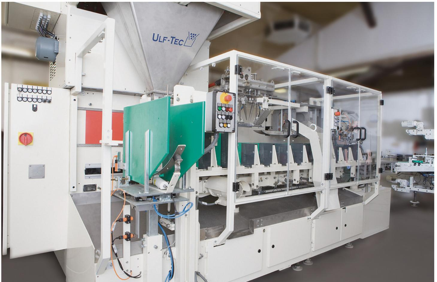
ULF-Tec-Verpackungsmaschinen können bis zu 110 vorgefertigte Klotz- und Spitzbodenbeutel pro Minute mit jeweils maximal 12,5 kg befüllen.
